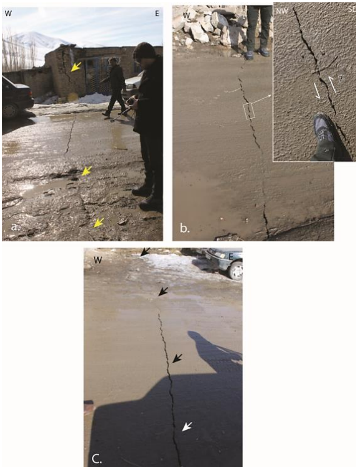
شکل ۵. گسیختگی های با جابجایی جزئی چپگرد در روستای گرناویک. گسیختگی با امتداد N10^{\circ}-20^{\circ}E .
